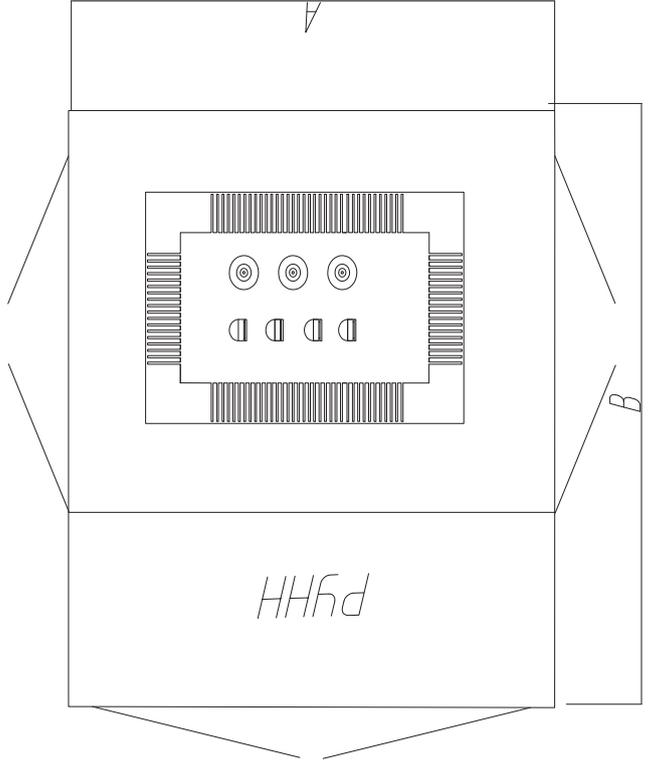
Типовая комплектация тупиковой КТП киоскового типа без внутренней ячейки мощностью 25-630 кВА
